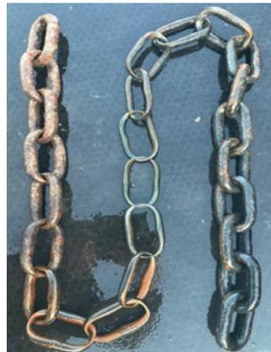
et peuvent conduire, à terme, à la **rupture de la chaîne ou de l'amarrage**.
